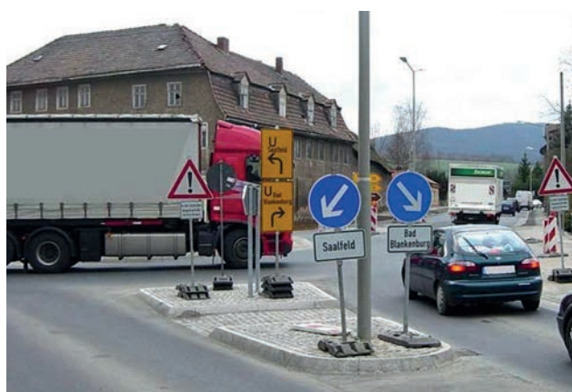
Bild 6: Falsche und irreführende Wegweisung im Bereich einer Umleitungsstrecke (Bild Korsch)
