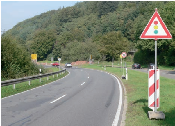
Bild 3: Ankuendigung einer Lichtzeichenanlage auf der Landstrasse
