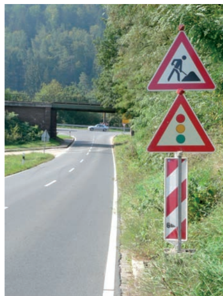
Bild 5a: Eine LSA wird angekündigt, die allerdings hinter der Einmündung rechts steht (Zeichen 1000-21 „Richtung der Gefahrstelle, rechtsweisend“ fehlt)
