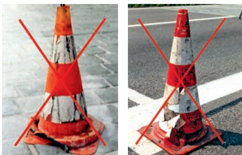
Bild 6: Unzulässige und abgenutzte Leitkegel sind gefährlich
