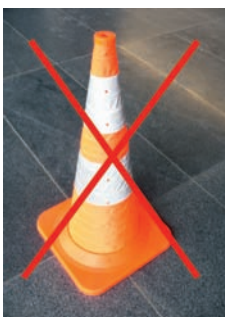
Bild 4: Zur Absicherung von Arbeitsstellen im öffentlichen Verkehrsraum nicht zugelassener Faltleitkegel (links) und korrekte Ausführung (rechts)
