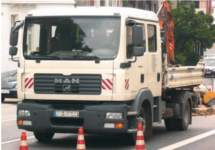
Bild 4: Warnmarkierung zu klein (halbe Streifenbreite), fehlendes Rundumlicht
