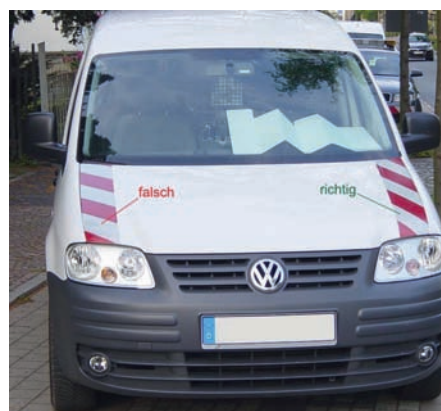
Bild 2: Falsche und richtige Anordnung der Warnschraffen (Foto Korsch)
