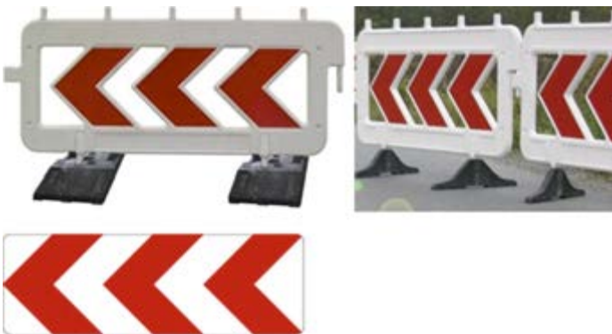
Bild 7: Als „Kurvengitter“ angebotenes Element (oben links). Im Katalog des Unternehmens wird nicht deutlich, dass keine Übereinstimmung mit dem Zeichen 625 besteht (unten links), da die Flächen zwischen den rot retroreflektierenden Flächen nicht ausgefüllt sind (oben rechts)
